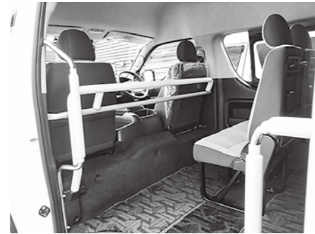
手すり等が設置された巡回バスの内部
